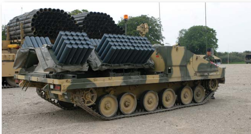
Гусенични минополагач Shielder са америчким системом Volcano
